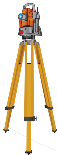
El teodolito es un instrumento de medición de ángulos verticales y horizontales utilizado en actividades ingenieriles.
