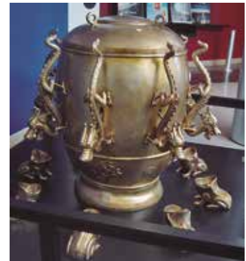
Sismoscopio antecesor del sismógrafo
